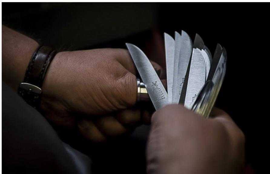
ゾーリングン式に研磨された風車のナイフはすべて「親指テスト」をしています。研磨されたナイフを親指の爪（あるいは試験用指輪）に軽く押し試みると、刃先がわずかにうねります。私たちはこの現象を「刃が現れる」と言っていますが、これは刃が極めて鋭い証拠で、「風車のナイフ」ならではの特徴です。
